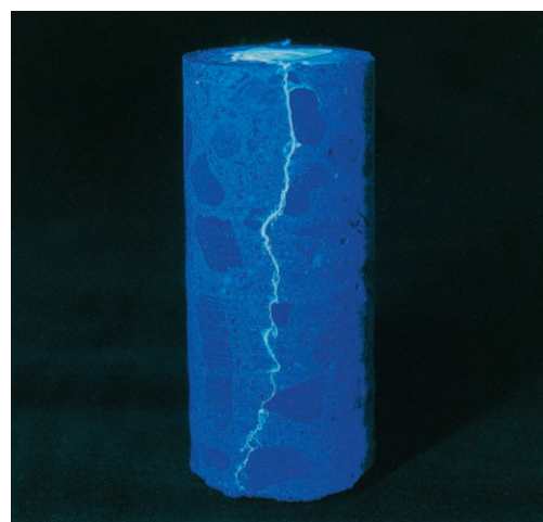
ブラックライトを照射した注入状況
